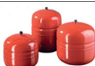
**Vaso di espansione:** assorbe le variazioni di volume subite dal liquido per effetto della variazione della temperatura di esercizio. In acciaio verniciato a polveri epossidiche di lunga durata con membrana fissa in gomma SBR. FORNITO SMONTATO
