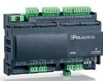
**MICROPROCESSORE I-PRO:** microprocessore evoluto di progettazione EMERSON LUMITY (DIXELL), a 10din, gestisce automaticamente la regolazione della temperatura dell'acqua, temporistiche e rotazione dei compressori, gli allarmi, visualizza sul display lo stato di funzionamento dell'unità, la temperatura di mandata e di ritorno dell'acqua dall'impianto e il codice degli allarmi.
