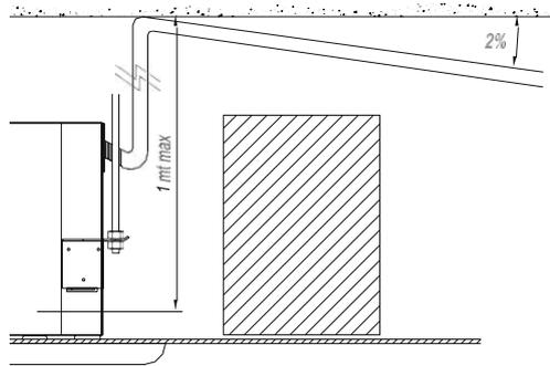
È consentito scaricare l'acqua ad un livello superiore all'unità di mt 0,75 (massimo), se il tratto di tubo ascendente sia verticale e posto in corrispondenza della flangia di scarico. Si può raggiungere un'altezza del genere perché la pompa di scarico condensa è provvista di una valvola di non ritorno. Tale fatto può essere utile se si devono superare ostacoli come travi.
