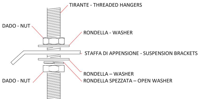
**ATTENZIONE** Le operazioni di posizionamento vanno eseguite con i dadi, dei tiranti di appendimento, allentati.
