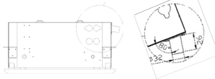
Lo scarico di Ø32 è compatibile con il tubo facilmente reperibile nel mercato (mod. NITAR HTB Ø32 con o-ring) e presente nella maggior parte degli impianti di scarico condensa già predisposti.
