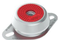
**Supporto antivibrante a campana:** riducono la trasmissione delle vibrazioni prodotte dalla macchina. Elemento elastico in gomma naturale resistente a temperature di esercizio da -20 a +90°C. Corpo metallico con superficie zincata UNI ISO 2081 Fe/Zn 15c1A bianca e acciaio UNI EN 10111 DD13.
