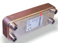
**Recupero totale di calore:** consiste in uno scambiatore a piastre saldobrasate in acciaio AISI 316. In base alla temperatura della sonda acqua di recupero, il gas caldo viene inviato nello scambiatore di recupero trasferendo all'acqua l'energia di condensazione.
