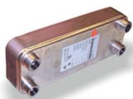
**Desurriscaldatore:** consiste in uno scambiatore a piastre saldobrasate in acciaio AISI 316. In base alla temperatura della sonda acqua di recupero, il gas caldo viene inviato nel desurriscaldatore recuperando fino al 25% del calore di condensazione. La condensazione viene poi completata sul condensatore standard con un aumento delle prestazioni del sistema.
