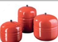
**Vaso di espansione:** assorbe le variazioni di volume subite dal liquido per effetto della variazione della temperatura di esercizio. In acciaio verniciato a polveri epossidiche di lunga durata con membrana fissa in gomma SBR. FORNITO SMONTATO
