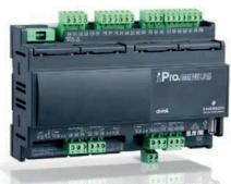
**MICROPROCESSORE I-PRO:** microprocessore evoluto di progettazione COPELAND controls, a 10din, gestisce automaticamente la regolazione della temperatura dell'acqua, tempistiche e rotazione dei compressori, gli allarmi, visualizza sul display lo stato di funzionamento dell'unità, la temperatura di mandata e di ritorno dell'acqua dall'impianto e il codice degli allarmi.
