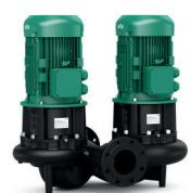
**Kit pompa gemellare:** n°1 pompa gemellare montata all'interno dell'unità, con una pompa impiegata come backup. Il kit è completo di valvola di ritegno sulla mandata della pompa gemellare, interruttore automatico di protezione e teleruttori di comando per ciascuna pompa. La gestione delle pompe viene affidata direttamente al microprocessore con commutazione a tempo (per equilibrare le ore di funzionamento).
