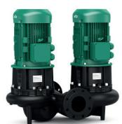
**Kit pompa gemellare:** n°1 pompa gemellare montata all'interno dell'unità, con una pompa impiegata come backup. Il kit è completo di valvola di ritegno sulla manda della pompa gemellare, interruttore automatico di protezione e teleruttori di comando per ciascuna pompa. La gestione delle pompe viene affidata direttamente al microprocessore con commutazione a tempo (per equilibrare le ore di funzionamento).
